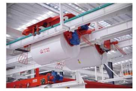
11 Бетон транспорт тележка
