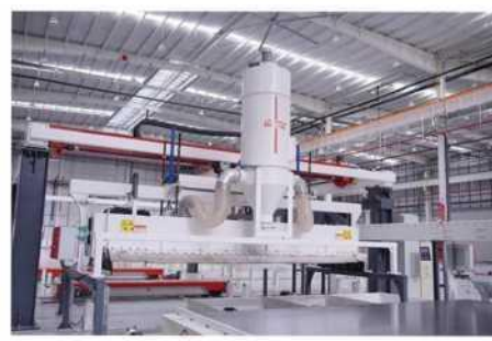
3 Роботы для установки форм
