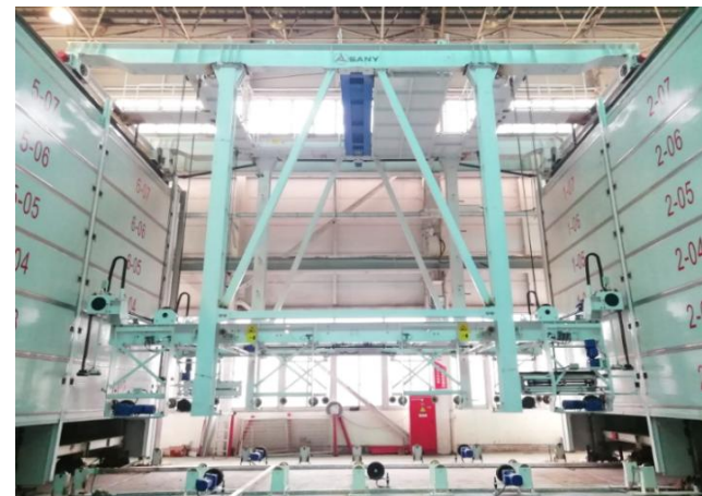
• Интеллектуальная система укладки и отверждения
