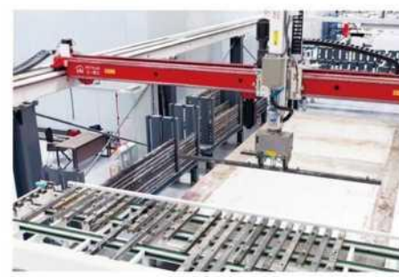
4 Роботы для размещения форм
