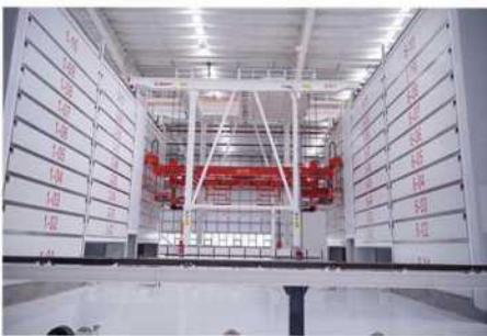
5 Кран-стакер и печь для отверждения
